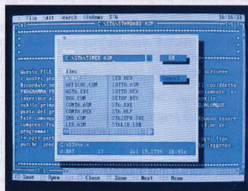
Fig.4 Per cambiare il nome del file STANDARD.ASM con ALIBABA dovrete scrivere C:\ST6\ALIBABA.ASM e poi premere ALT F3 . Se desiderate cambiare il listato del file TIMER dovrete scrivere C:\ST6\TIMER.ASM .
